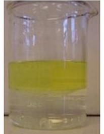
Nous obtenons alors un mélange hétérogène essentiellement formé d'eau (encore un peu trouble) et d'huile. Pour séparer l'huile qui surnage de l'eau, nous allons utiliser une **ampoule à décanter**
