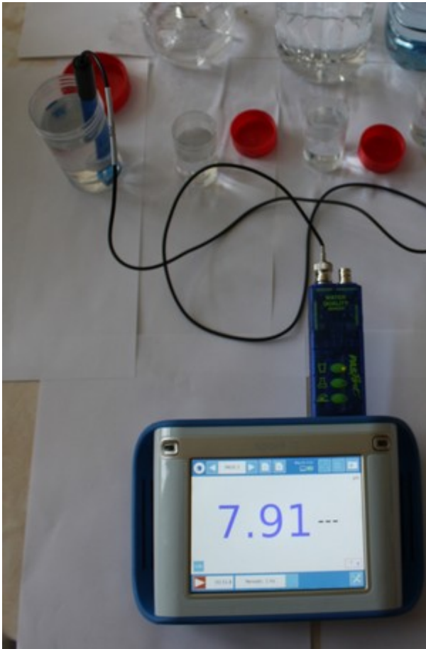
Mesure du pH de l'eau de la Loire
