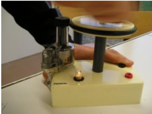
Pour produire une tension électrique, l'alternateur doit être mis en mouvement (de rotation).
