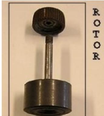
Le rotor est de forme cylindrique. Il est monté sur un axe central.
