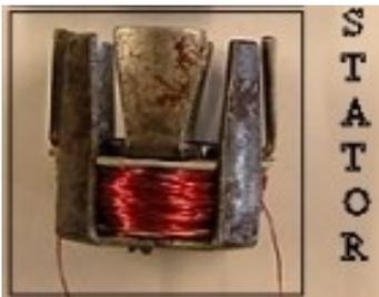
Le rotor bouge dans une cage en acier, au dessus d'une bobine de fil de cuivre.
